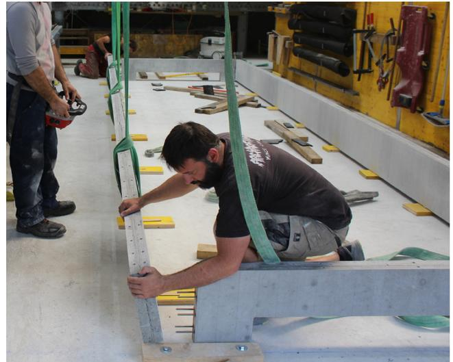
Im Betonwerk wurden alle Teile mit einem CNC-Bearbeitungszentrum aus grossformatigen Tafeln ausgeschnitten, gebohrt und an Flächen und Kanten vorbereitet. Anschliessend wurden die Elemente zusammengesetzt, verklebt und verschraubt.
