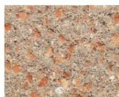
Redotto-RC Mauerstein enthält 70 % Recycling-Zuschlag im Kern und Vorsatz. Dieser besteht beim RC2 graun aus min. 70 % Beton-RC-Splitt und max. 30 % Ziegel-Backstein-RC-Splitt.
