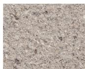
Redotto-RC Mauerstein enthält 70 % Recycling-Zuschlag im Kern und Vorsatz. Dieser besteht beim RC1 naturgrau aus min. 90 % Beton-RC-Splitt und max. 10 % Ziegel-Backstein-RC-Splitt.
