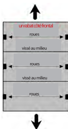
Couverture de saut à la perche „Strong” en 1 partie, abaissable, mobile vers l'arrière et l'avant
